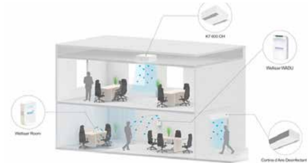
Un esquema de com actuen els diferents dispositius d'Airtècnics per crear la cortina d'aire. || AIRTÈCNICS
